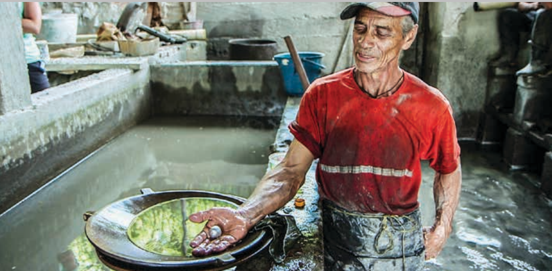
عامل منجمي يوضح طريقة استخدام الزئبق في تعدين الذهب الحرفي وعلى نطاق ضيق في سيغوفيا، كولومبيا. الصورة بعدسة باتريك فرايز
